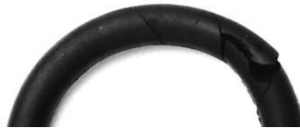
Рис. 10.10 Перекрученное уплотнительное кольцо с порезами на поверхности
