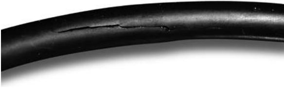
Рис. 10.11 Уплотнительное кольцо, поврежденное взрывной декомпрессией
