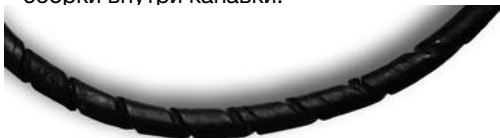
Рис. 10.9 Перекрученное уплотнительное кольцо со спиральными отметками
