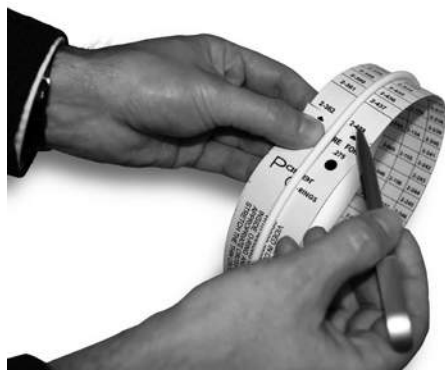
Рис. 5.9 Определение размера уплотнительного кольца при помощи измерительной ленты
