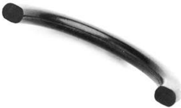
Рис. 10.8 Пример повреждения, вызванного высокой остаточной деформацией при сжатии
