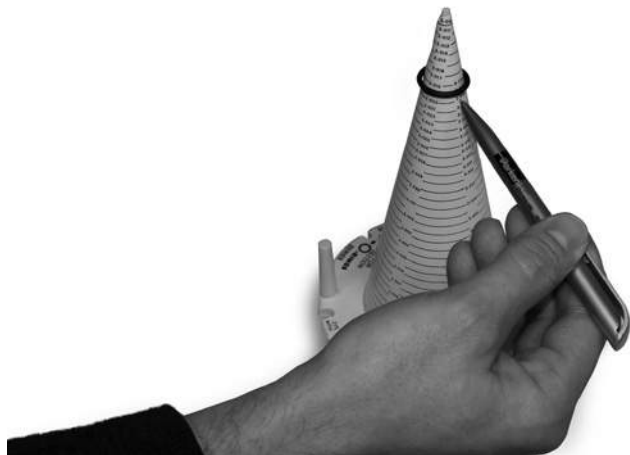
Рис. 5.8 Определение номера размера 2-xxx при помощи измерительного конуса
